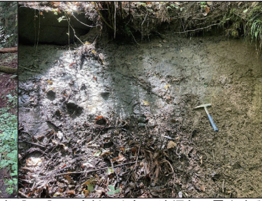
[P10] 下流斜面脚部の洗堀部に露出する砂岩でφ50~70mmの泥岩円礫を含む、傾斜30°程度、ハンマー打撃で濁音を発する程度の硬さ
