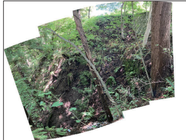
[P1] 計画施設上方の滑落崖頭部、道路擁壁が設置され裸地も確認される、沢状地形部には流水跡あり
