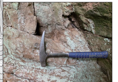
[P8] 露出する凝灰岩は溶結しハンマー打撃で濁音を発する程度の硬さ
