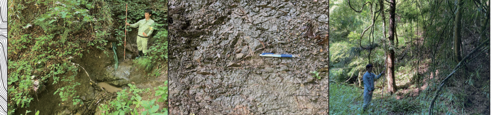
[P10] 東側支沢上流の砂防堰堤下流側、右岸側、地すべり地形の末端部に崩積土が沢床露岩を覆いせり出す
