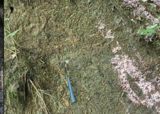
[P4] 左岸側は塊状無層理の泥岩～細粒砂岩で、ハンマー打撃で濁音を発する程度の硬さ、N13° E70° E方向の亀裂がやや発達する
