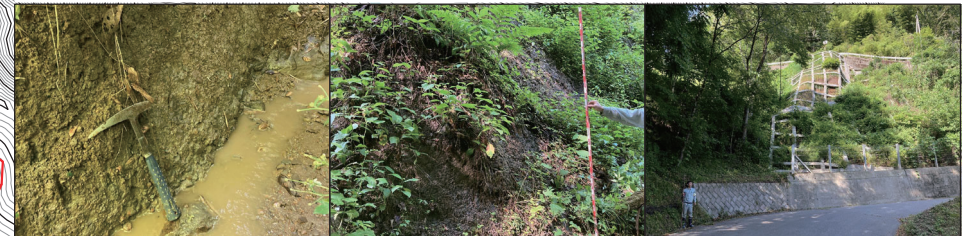
[P11] 地すべり地形末端部の崩積土、土砂化する
