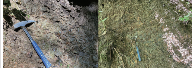
[P4] 左岸側は塊状無層理の泥岩～細粒砂岩で、ハンマー打撃で濁音を発する程度の硬さ、N13° E70° E方向の亀裂がやや発達する
