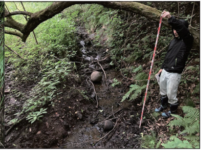
[P9] 東側の沢、流路幅1m程度、沢底堆積物少ない、沢底の転石は最大φ0.4m程度の円礫
