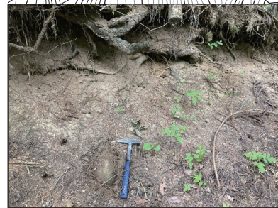
[P1] 礫混じり火山灰質砂、φ5~20mm最大礫径200mmの安山岩の円礫を含む
