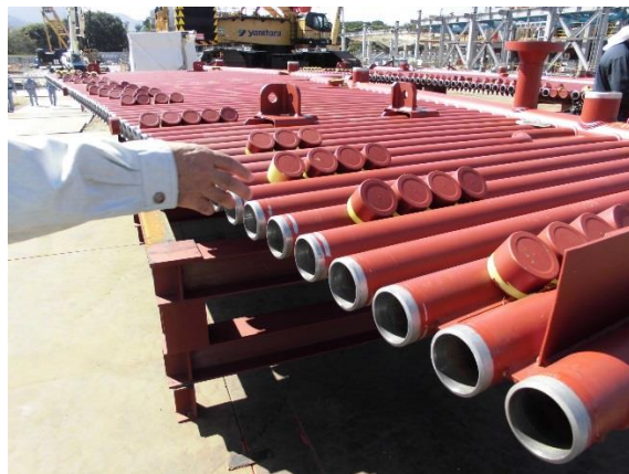
ボイラパネル
